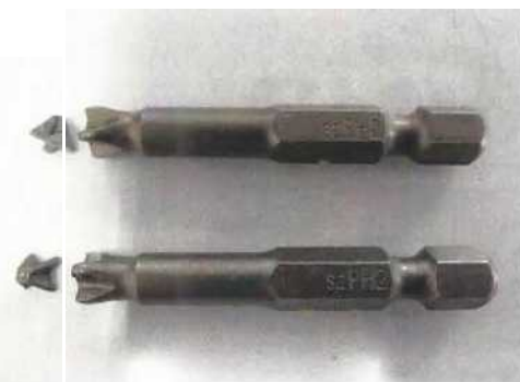
Фото “D” Вид после теста: RSC Bit, PH2x50mm
