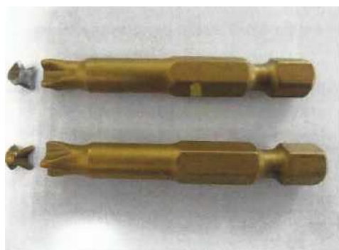
Фото “Е” Вид после теста: RSC Bit, PH2x50mmTiN
