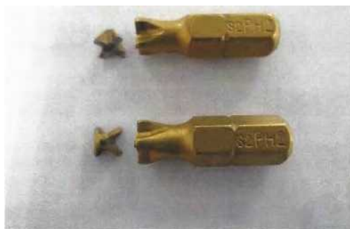
Фото “С” Вид после теста: RSC Bit, PH2x25mm TiN
