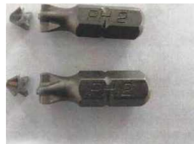
Фото “В” Вид после теста: RSC Bit, PH2x25mm
